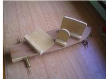
découpe du fond et des "couples" dans du ctp de 3 mm
