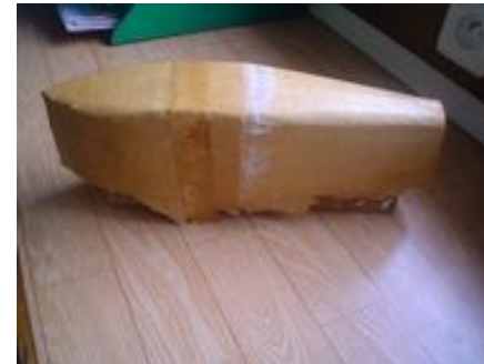
la première couche se pose sans colle, on ne l'ajoute que pour les suivantes en croisant la bande ajoutée
