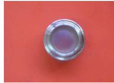
Le verre est en place. Pour obtenir le relief il faut retourner le manchon. Ponçage fin au tour.
